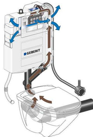
Afbeelding 171: Geberit spoelreservoir Sigma 12 cm met voorbereiding voor het inbouwen van de bedieningsplaat Sigma40 met geurafzuiging DuoFresh
